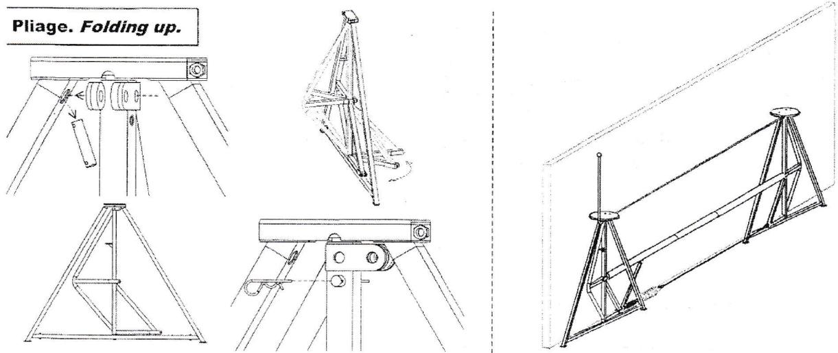
**Transformation en chevalets à ancrer. Transformation in Anchored frame.**
