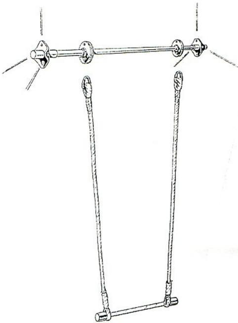
**Réglage du plan de rotation des roulements,** selon l'angle des suspentes par rapport à la barre. Ce réglage est recommandé pour assurer un excellent ballant et éviter des contraintes anormales sur l'équipement.
